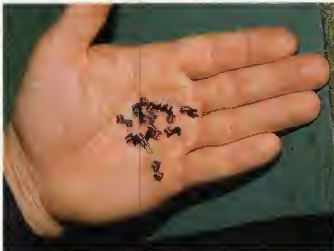
Fünf Millimeter groß sind die Spulen, die einmal die Nadeln gegen das Papier schleudern werden
